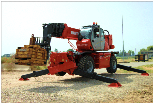
Unterschiedliche Böden: Vor dem Aufstellen der Maschine ist die Tragfähigkeit des Bodens zu klären.
