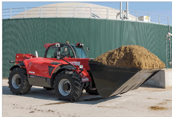
Verdichtetes oder feuchtes Schüttgut ist besonders schwer.
